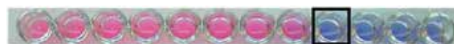
Billede 2: MIC bestemmes ud fra den første brønd uden vækst (blå). Den sorte firkant angiver MIC. Kilde: Thermo Fisher Scientific, procedurevejledning , Sensititre YeastOne august 2012.
