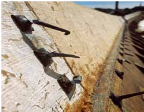
Jernnagler med klinkplader holder plankerne sammen. Foto: Werner Karrasch. Copyright: Vikingskibsmuseet i Roskilde
