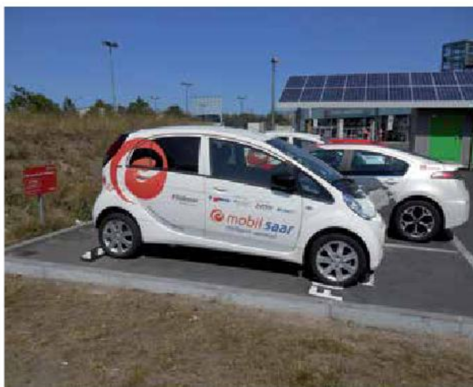
Opladestation for elbiler og elcykler ved "fremtidsbanegården" Südkreuz. Strømmen kommer fra solcellerne over halvtaget, minivindmøller og andre vedvarende energikilder til et batterilager. Ladestationen er forbillede for lignende anlæg ved trafikknudepunkter.
