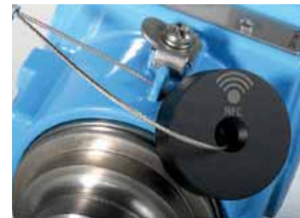
RFID-tags; enkel identifikation af målepunkter.
