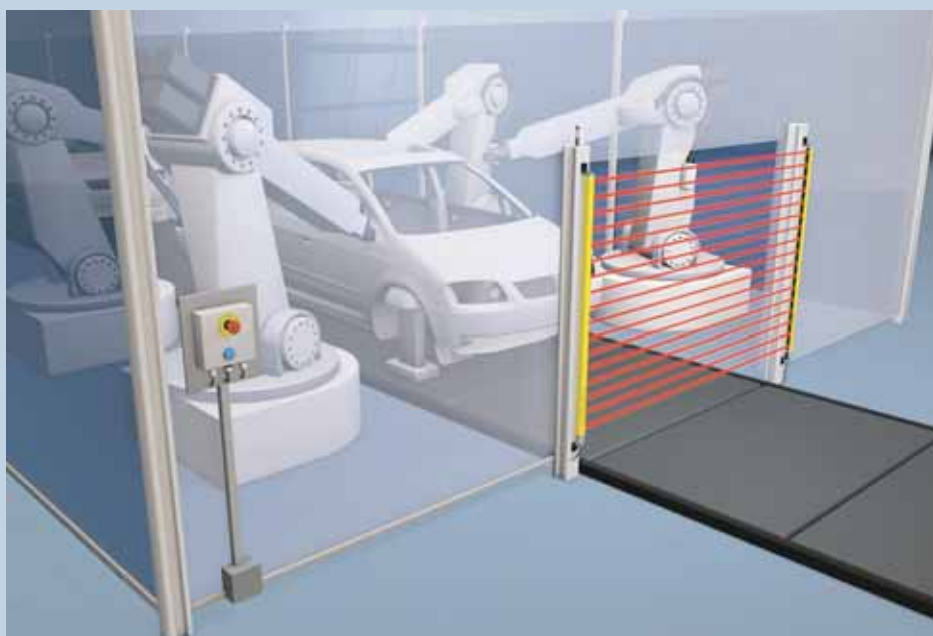
SPG - Processtyret adgangssikring uden muting-sensorer inden for intern transport.
