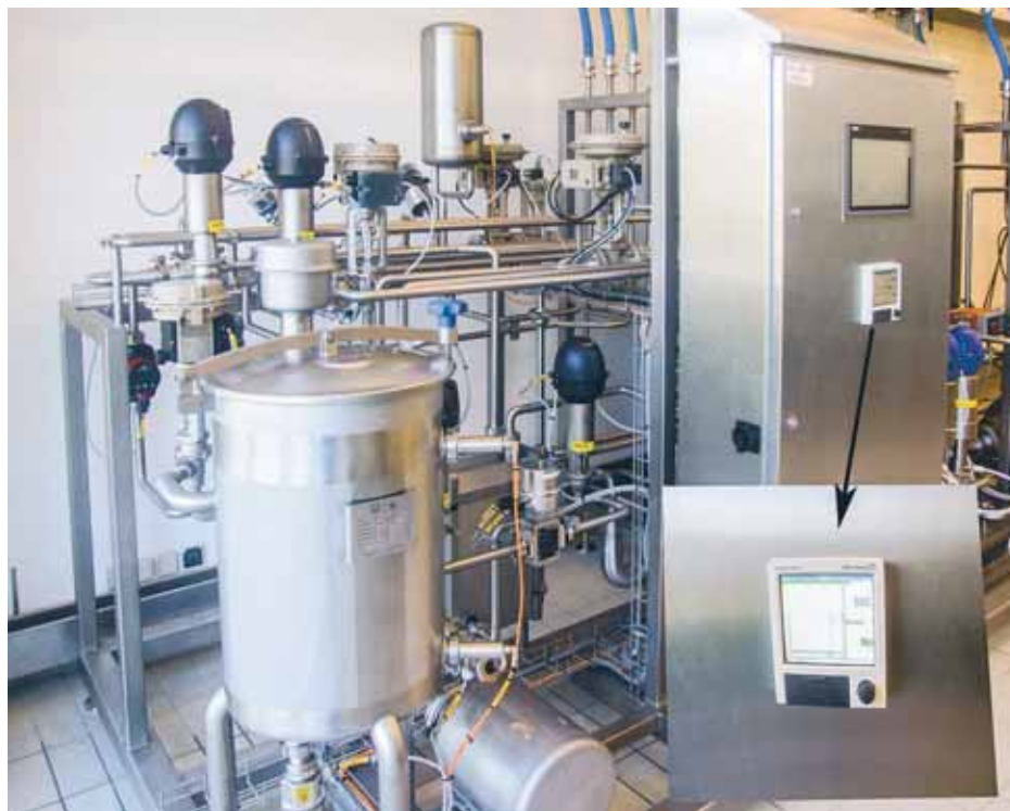
Pasteuriseringsprocessen kan overvåges via en lille fiks datamanager, Ecograph T RSG35.
