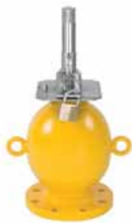
FQG kildebeholder beskytter arbejdere på anlægget imod stråling.
