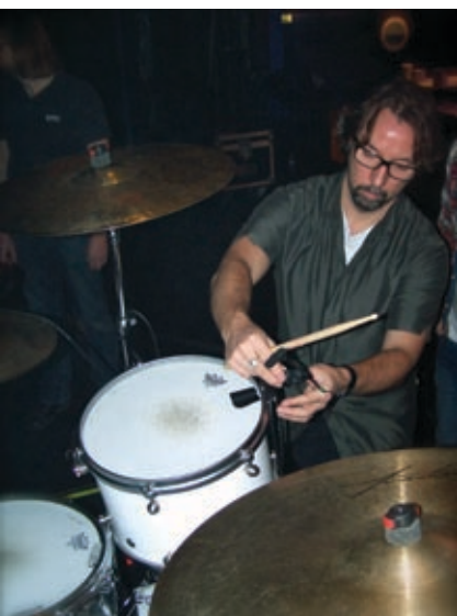
Bo Brinck fra DPA Microphones monterer DPA 4099 på alle tom toms på trommesættet, der mikes op uden brug af stativer.
